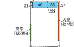
内壁と高窓は左右で取付け位置を変更できます。(同じ面には取付けできません。)
