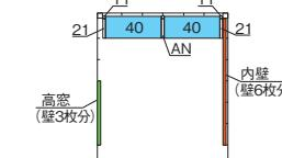
内壁と高窓は左右で取付け位置を変更できます。(同じ面には取付けできません。)
