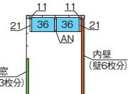
内壁と高窓は左右で取付け位置を変更できます。(同じ面には取付けできません。)
