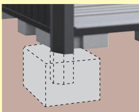
必ずアンカーアルミ工事・転倒防止工事を行ってください。
