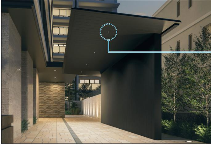
カーポートの屋根下に取り付け、夜間のエントランスを美しく演出する環境保全と省エネに配慮したLEDダウンライトです。低電圧で感電の心配が少なく、手軽に設置できるDC12Vタイプです。
