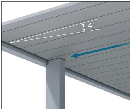
屋根勾配と屋根材が同方向で排水されやすい設計。
