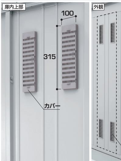
庫内の換気に役立つ通気ガラリが4個付いています。換気時にも虫の侵入を防ぐ安心設計です。庫内側のカバーを上下することで換気量が調節でき、ほこりや雨水の浸入も低減できます。
