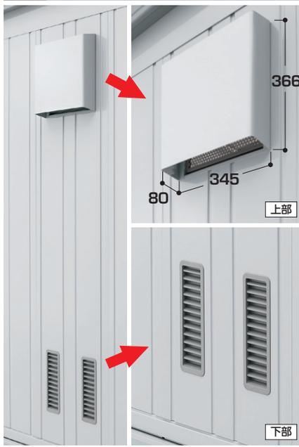
上部はフード付の鋼板製メッシュパネル(φ8穴)、下部は庫内からカバーを上下することで換気量が調節できる樹脂製のガラリです。
