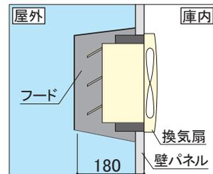
埋め込み部+シャッター部分が180mm以下の換気扇にご使用ください。
