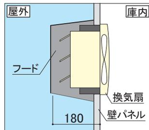
埋め込み部+シャッター部分が180mm以下(フード内有効寸法)の換気扇にご使用ください。
