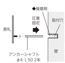
裏側にボルトが付いていますので付属のアンカーシャフトを回し込んで固定してください。
