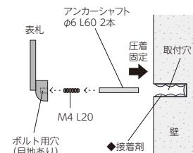
裏側にボルト用の穴が開いていますので付属のボルトを回し込み固定し、アンカーシャフトを回し込んで固定してください。
