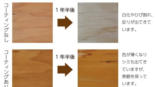
キセノンウェザーメーター屋外暴露試験による。
