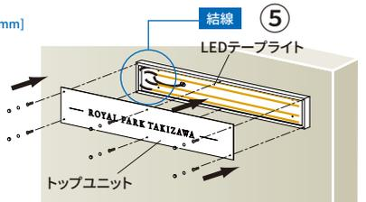
W3,W4タイプ [LED交換時の手順] 1. 上記①と同様にトップユニットをはずします。 2. LEDテープライトをはがし結線をはずします。 3. 新品LEDテープライトの剥離紙をはがし乳半アクリルに貼付けます。
