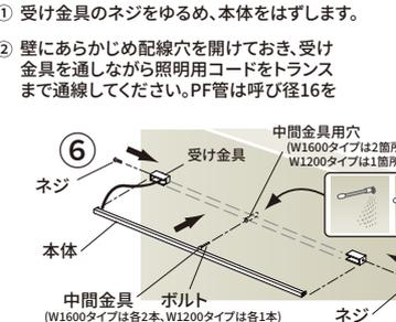
使用中に穴の出口は不乾性パテで塞いでください。その際、受け金具の取付けに支障がないようご注意ください。
