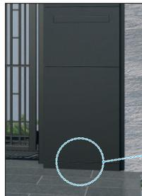
門扉取り付け仕様の場合は、埋め込み深さを500mm（門扉：ジオグランテ、ラグレシア、J.モダン、モンブレム）と480mm（門扉：グランクロス、レリアアハイタイプ）を推奨し、±25mmの範囲で埋め込み調整が可能です。機能門柱と門柱高さを合わせることができます。
