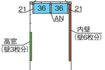
※内壁と高窓は左右で取付け位置を変更できます。(同じ面には取付けできません。)
