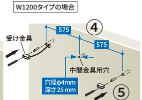
⑥ 中間金具用穴に接着剤を充填してください。その穴に中間金具が入るようにしながら本体を受け金具に取付けネジで固定してください。照明の発光確認を行い完成です。
