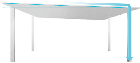
屋根の片側に勾配を設けることで雨水を誘導。
