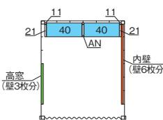
※内壁と高窓は左右で取付け位置を変更できます。(同じ面には取付けできません。)
