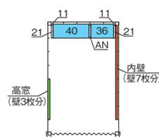
※内壁と高窓は左右で取付け位置を変更できます。(同じ面には取付けできません。)
