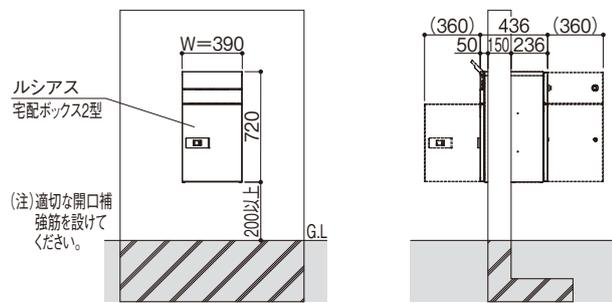
●【乾式柱納まり】宅配ポスト2型+H10端柱
