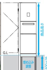
門扉取り付け仕様の場合は、埋め込み深さを500mm(ジオグランテ、ラグレシア、J.モダン、モンプレム)と480mm(グランクロス、レシリアハイタイプ)を推奨し、±25mmの範囲で埋め込み調整が可能です。機能門柱と門柱高さを合わせることができます。
