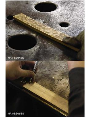
真鍮の素材感と彫金文字の味わいが楽しめるネームプレートは職人の 手仕事により一点ずつ丁寧に仕上げています。真鍮のプレートをハンマーで 叩くことによって生み出される槌目模様。一文字一文字楔と金槌で彫り 込んで刻まれた文字は、同じものが存在しない一点ものです。最後に黒 染めエイジング加工で使い込んだ風合いを表現しています。真鍮の魅力 と手仕事の彫金文字の技の魅力が組み合わさり独特の存在感を醸し出し ます。時間を重ねるほどに深まる表情の変化をお楽しみいただけます。
