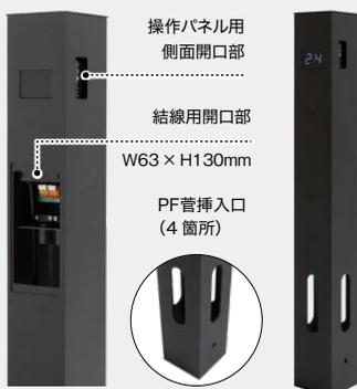
※ PF管挿入口は4箇所ありますが、φ16PF管・φ16CD管は3本ポール内部に引き込むことができます。4本以上引き込むことはできません。
